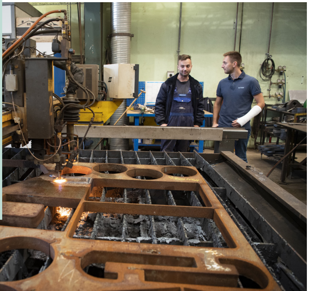
Dennis Jelle og Nick Palk ved skæremaskinen som kan skære med skærebrænder og plasmaskærere.
